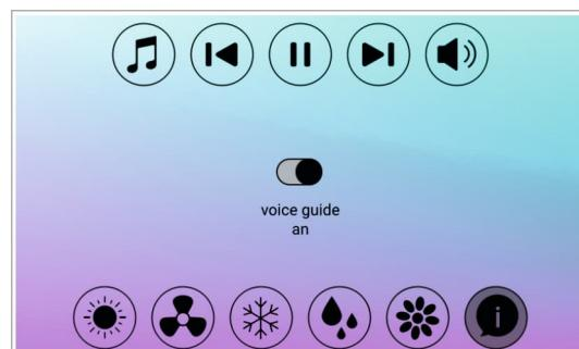
Der VOICE GUIDE führt den Nutzer durch die gesamte Bedienung. Diese Funktion kann jederzeit ein- und ausgestellt werden.
