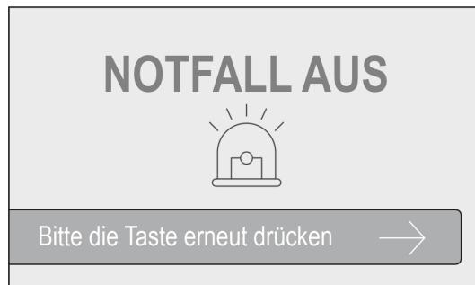
Wird der Taster NOTFALL AUS betätigt, schaltet das Gerät bis auf das INTERIOR DISPLAY ab. In diesem Zustand wird im Display angezeigt, dass der Taster NOTFALL AUS betätigt wurde.
