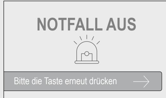
Wird der Taster NOTFALL AUS betätigt, schaltet das Gerät bis auf das INTERIOR DISPLAY ab. In diesem Zustand wird im Display angezeigt, dass der Taster NOTFALL AUS betätigt wurde.
