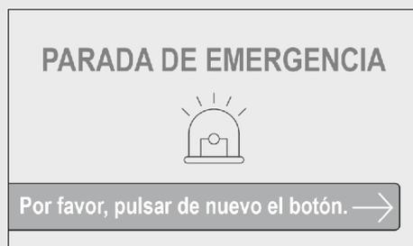
Si se pulsa la tecla PARADA DE EMERGENCIA, el equipo se apaga a excepción de la INTERIOR DISPLAY. En este estado se indica en la pantalla que se ha pulsado la tecla PARADA DE EMERGENCIA.
