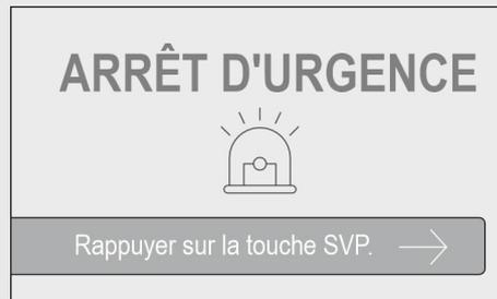
Si le bouton d'ARRÊT D'URGENCE est actionné, l'appareil s'arrête, excepté l'INTERIOR DISPLAY. Dans ce cas, l'écran signale que le bouton d'ARRÊT D'URGENCE a été actionné.
