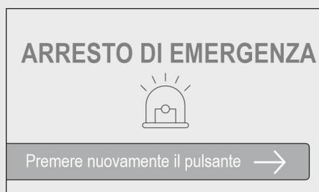
Se viene azionato il tasto ARRESTO DI EMERGENZA, l'apparecchio si spegne a esclusione dell'INTERIOR DISPLAY. In questo stato, nel display viene visualizzato che il pulsante ARRESTO DI EMERGENZA è stato attivato.
