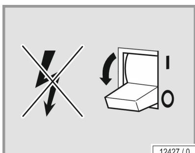
Um das Gerät vorübergehend oder endgültig außer Betrieb zu nehmen, muss das Gerät elektrisch getrennt werden.
