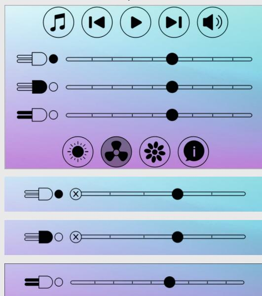
Die Lüftung kann für Gesicht, Körper und Fuß getrennt eingestellt werden. Ändert der Nutzer nichts, wird die Lüftung automatisch an die Temperatur angepasst.
