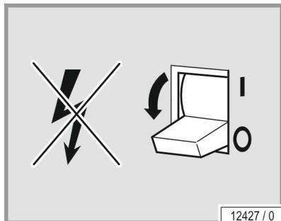
Wenn an den Geräten gearbeitet werden soll, müssen diese freigeschaltet werden. Das bedeutet, dass alle spannungsführenden Leitungen ausgeschaltet werden müssen.
