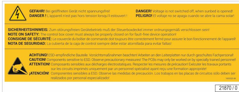
Der Aufkleber befindet sich auf dem 'Teileträger Steuerung'.
