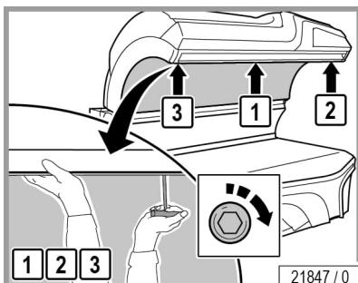
Der Zusammenbau erfolgt in umgekehrter Reihenfolge.
