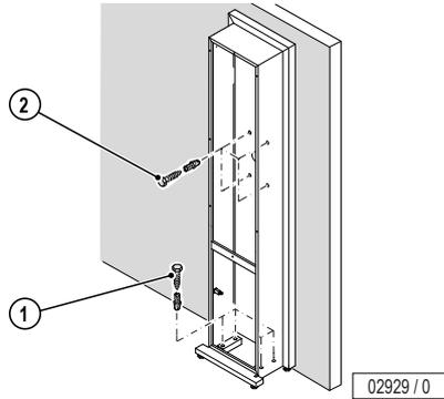
Wird zusätzlich ein Tower-Desk montiert, ist die Abdeckung (1) zwischen Tower und Wand zu montieren und der Tower an Boden (2) und Wand (3) zu befestigen.
